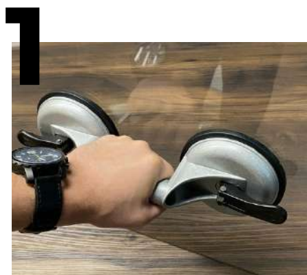
1 Закрепите стекло вакуумными держателями
